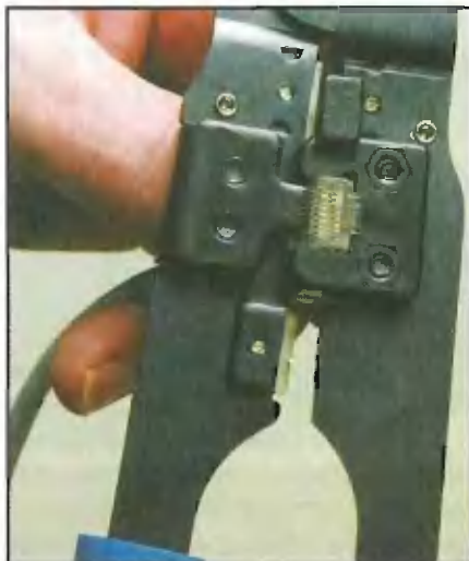
Крепление кабелей к портам. Разложив провода в разъеме, контакты последнего прижимают к проводам специальной обжимкой
