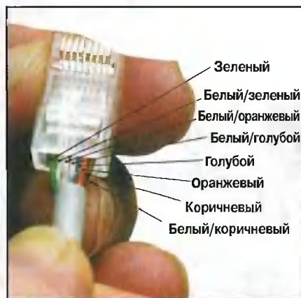
Разъем для 4-жильного провода. К разъему четыре пары проводов подсоединяют вполне определенным образом. Жилы имеют цветовую маркировку, соответствующую их стандартному назначению
